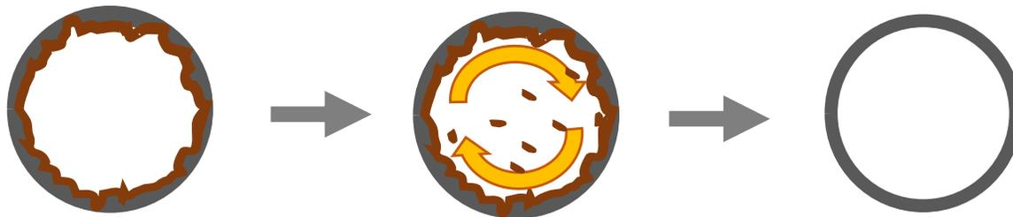
水圧洗浄・セラミック・サンドブラスト等で研磨
