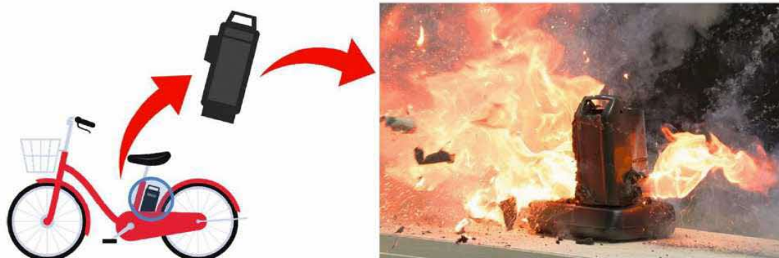
電動アシスト自転車用非純正バッテリーから発火する様子(再現イメージ映像)
