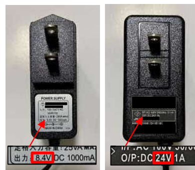
類似の形状でも出力電圧の異なる充電器（例）
