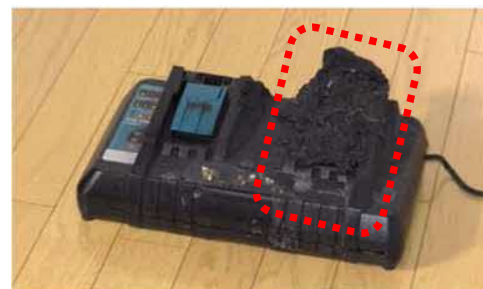
充電式電動工具用非純正バッテリーの発火 （再現イメージ映像）
