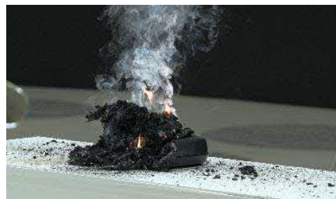
電動アシスト自転車用非純正バッテリーの発火 （再現イメージ映像）
