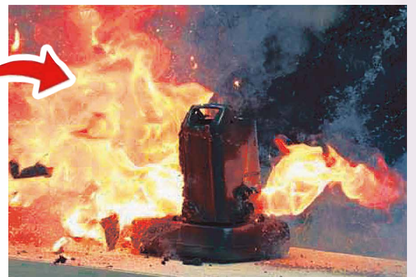
電動アシスト自転車用非純正バッテリーから発火する様子 (写真: (独)製品評価技術基盤機構)
