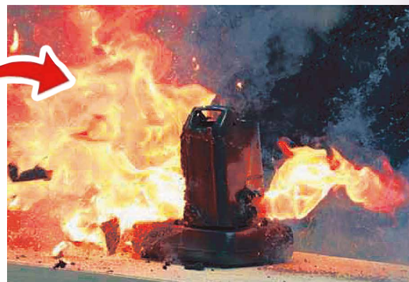
電動アシスト自転車用非純正バッテリーから発火する様子 (写真: (独)製品評価技術基盤機構)
