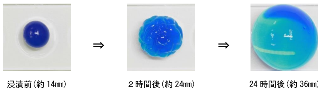
写真2 腸液を想定した模擬液に浸漬して膨らむ様子（例） 13
