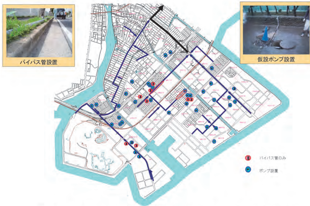
図8.3 応急復旧(仮設ポンプ、バイパス管)設置箇所(平成26年2月時点)
