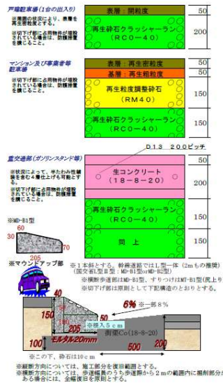
歩道切下げ等に伴う舗装復旧断面図
