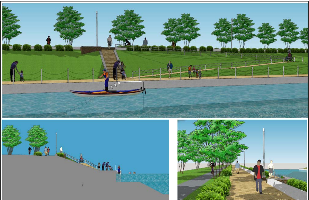
図 4.43 D2 ゾーン B案（緩傾斜化・緑化・嵩上げ）イメージ（例）
