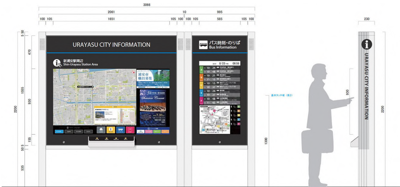
49V ディスプレイ ※各のりばの先発/次発バスの表示とのりば配置図など
