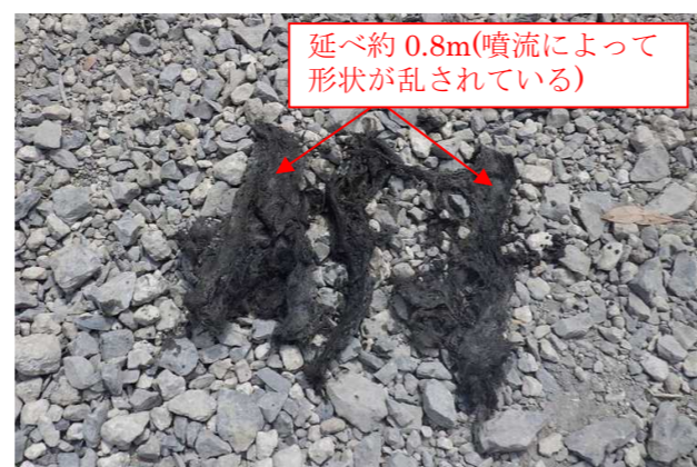
写真 1-2 埋設物の外観
