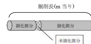
図 2-3 改良体の連続性の概念図
