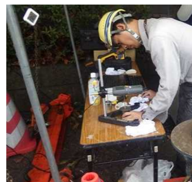
写真 2-3 粘度測定状況
