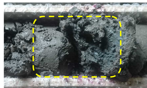
写真 2-16 コア内部の固化状況 (円形 No. 5)
