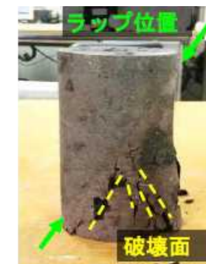
図 3-11 施工間隔 25 日のコア破壊状況
