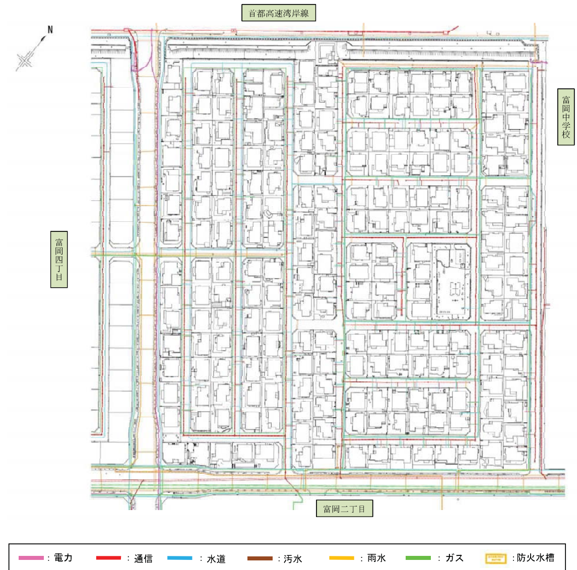
図-1.7 埋設管敷設状況平面図
