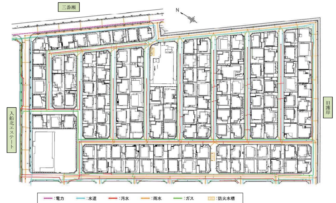
図-1.7 埋設管敷設状況平面図
