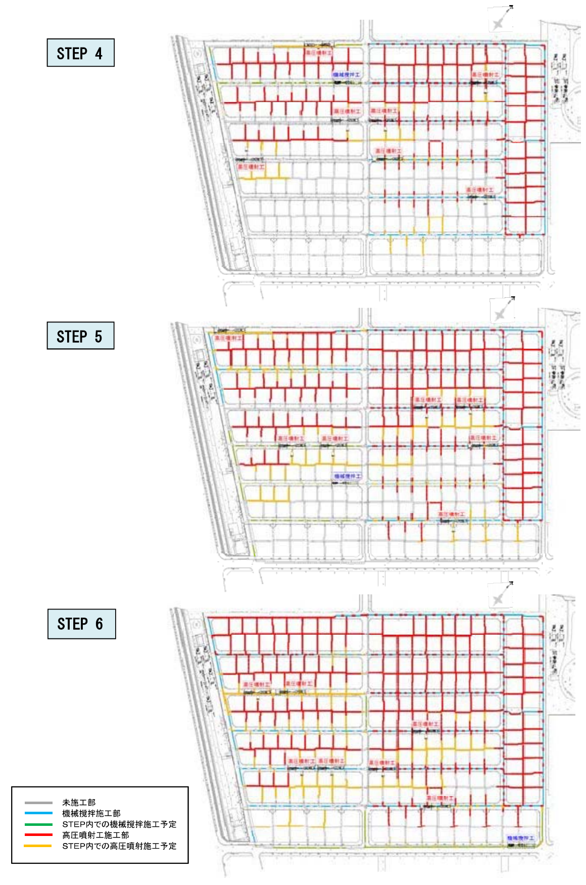
図-2.24 各 STEP における施工状況と機械配置例
