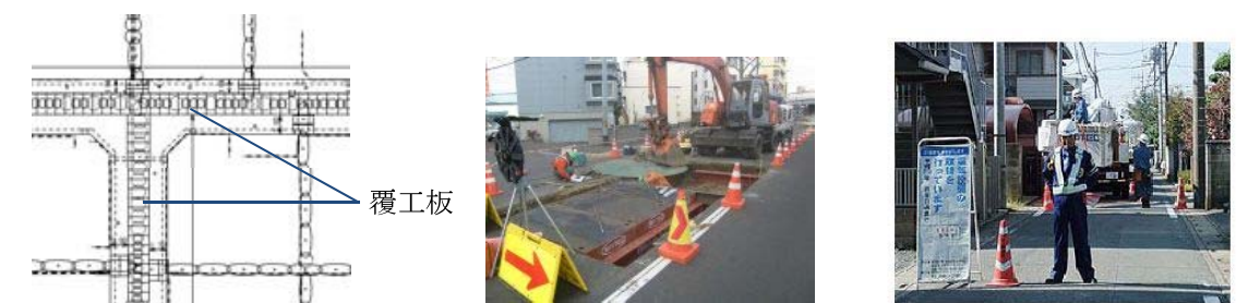
道路覆工板 配置計画例（平面図）
