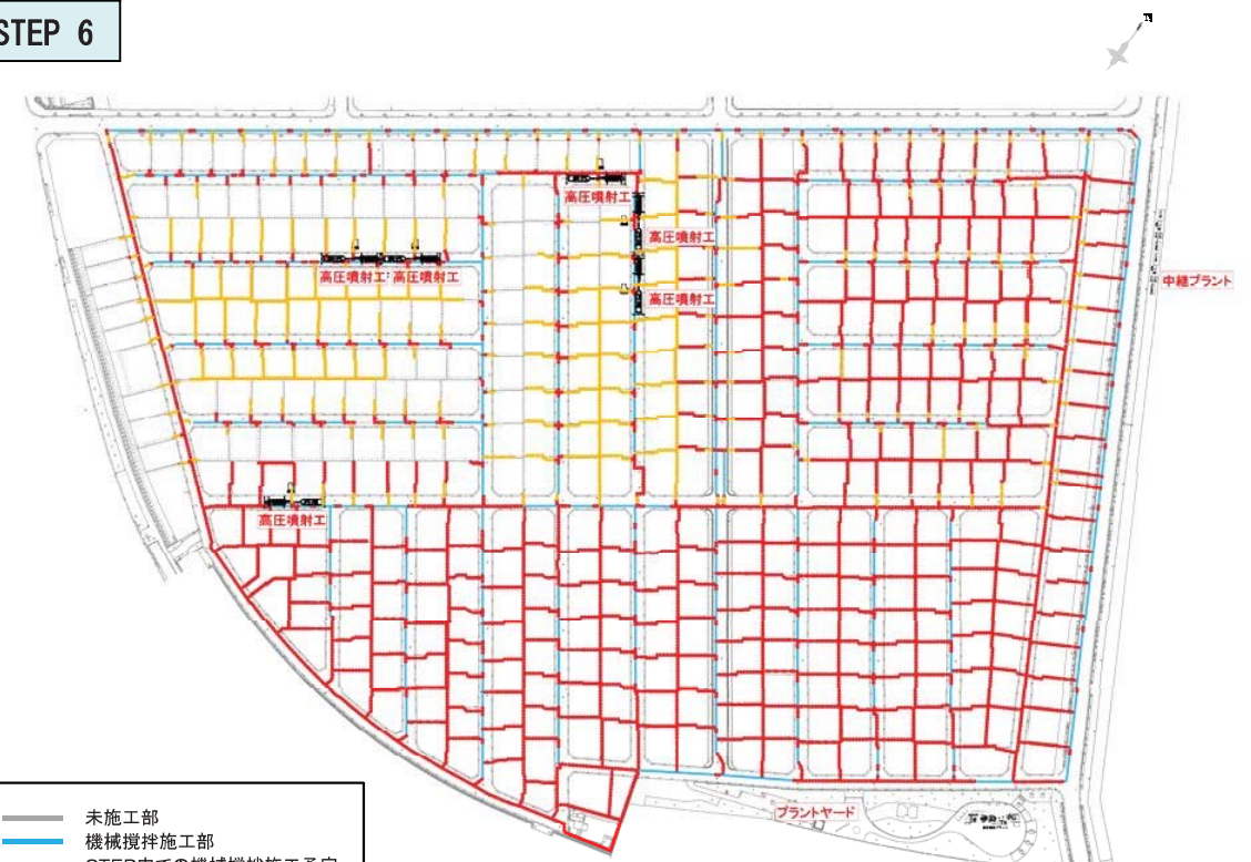
図-2.33 各 STEP における施工状況と機械配置例
