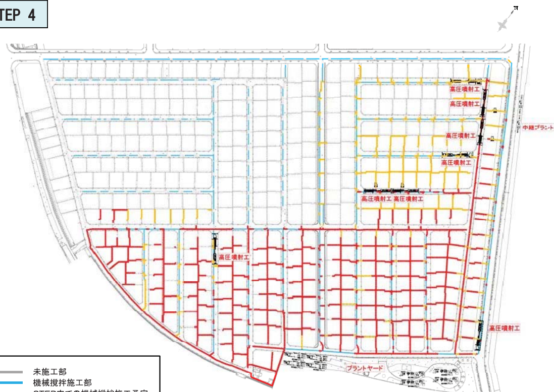
図-2.32 各 STEP における施工状況と機械配置例
