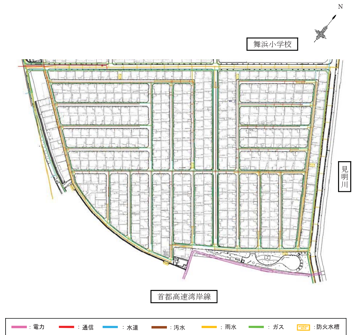
図-1.8 埋設管敷設状況平面図
