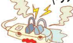
トラッキング現象
