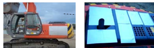
写真-5.1 カルムーンシート貼付事例
