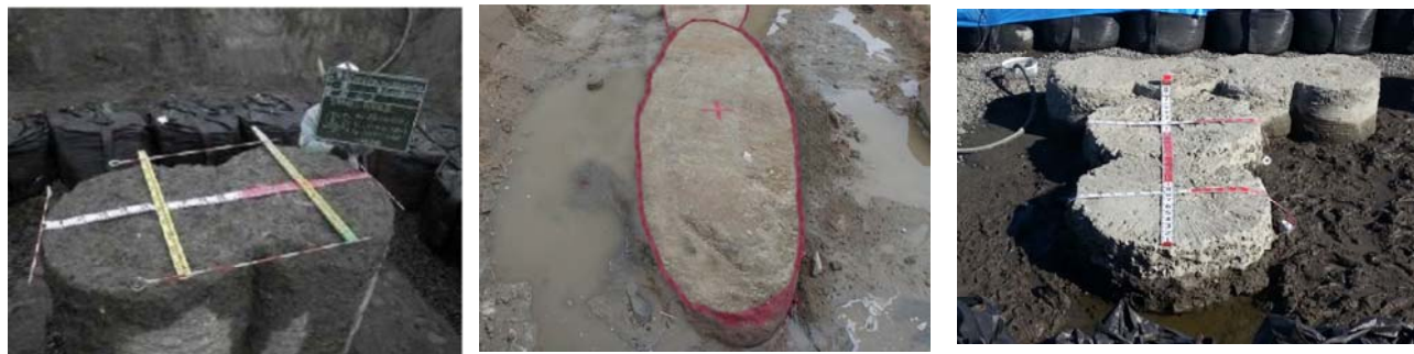
機械攪拌工法
