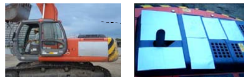
写真-4.1 カルムーンシート貼付事例
