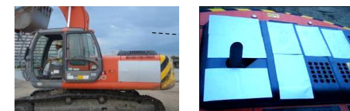
写真-4.1 カルムーンシート貼付事例
