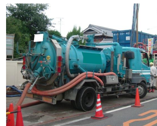
写真-5.2 バキューム車の例
