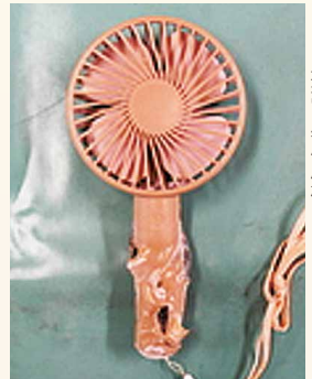
落下による異常発熱で持ち手が溶けた携帯用扇風機
