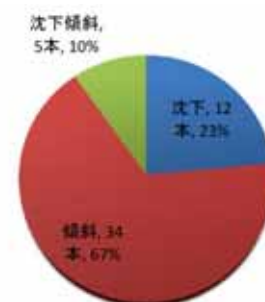
新町電柱被害割合
