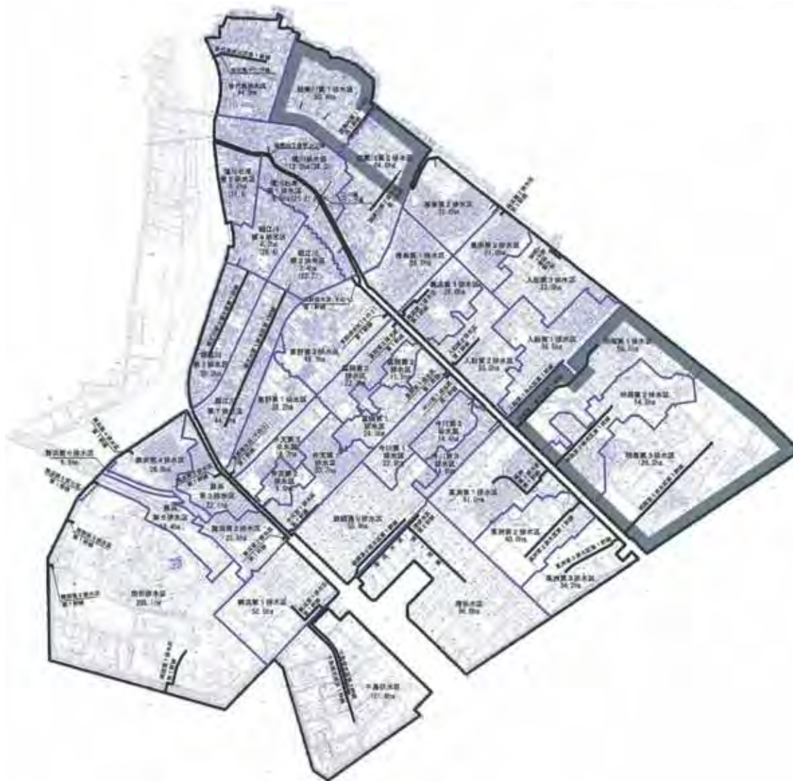
図 1.3-3 雨水幹線管路図および排水区分
