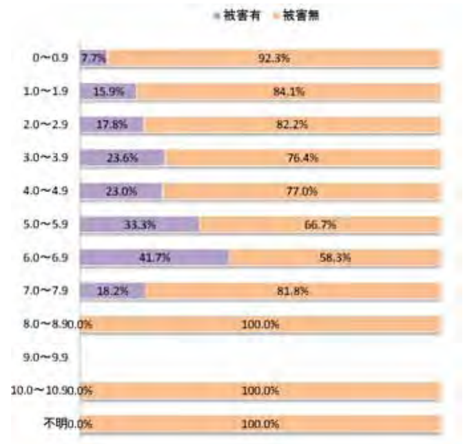
图 3-12 土被り別管路被害割合
