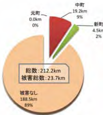
図 3-1 地区別管路被害延長
