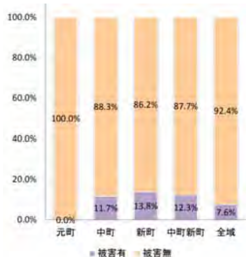
図 3-4 地区別マンホール被害割合
