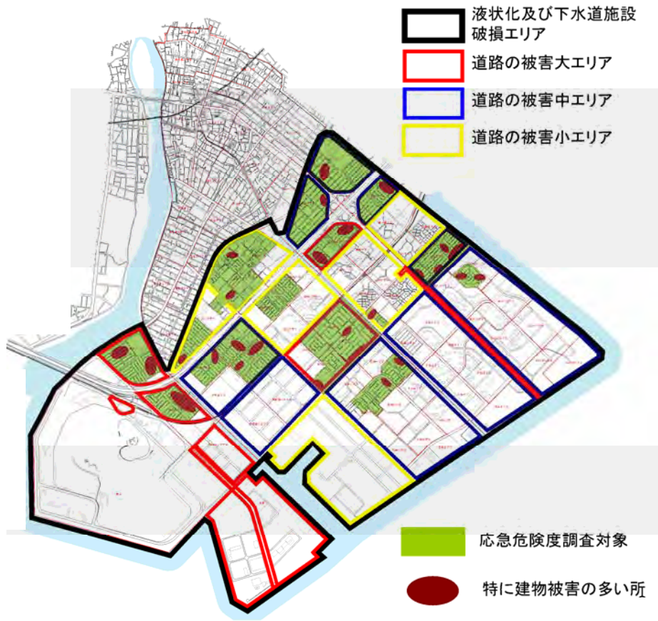
図 1-1 道路被害の集中箇所
