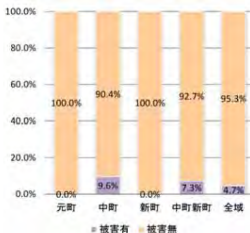
図 3-16 地区別マンホール被害割合
