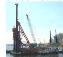
写真-2 SAVEマリン単装船 (船体寸法32m×13m×喫水1.3m)
