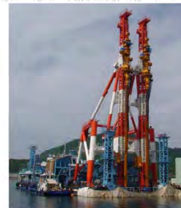
写真-1 SAVEマリン2連装船 (船体寸法60m×26m×喫水2.0m)
