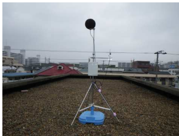
写真4 - 1 - 2 航空機騒音測定状況(今川記念館)
