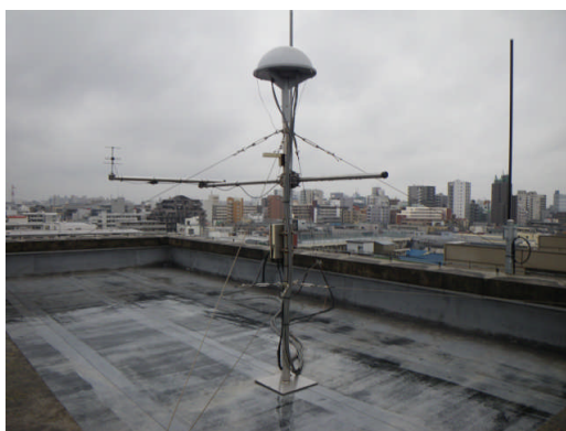
当代島 航空機識別センサー設置状況
