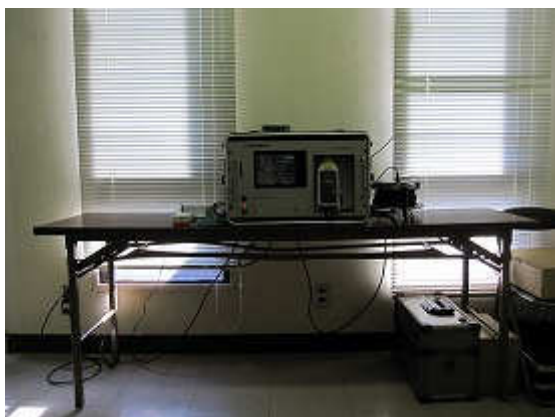
今川 騒音測定器本体設置状況
