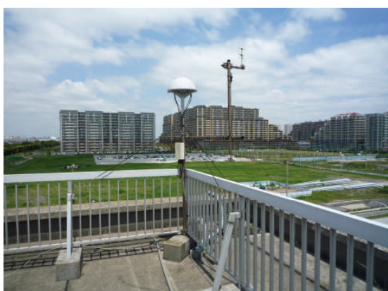
高洲 航空機識別センサー設置状況
