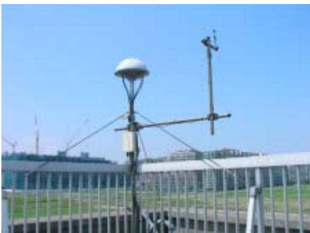
右：航空機接近検知識別センサー
