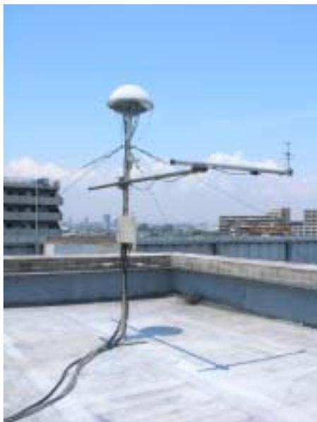
右：航空機接近検知識別センサー
