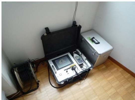
明海 騒音測定器本体設置状況
