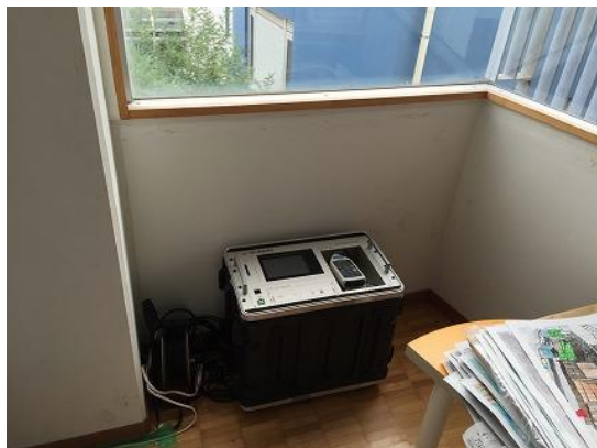
明海 騒音測定器本体設置状況
