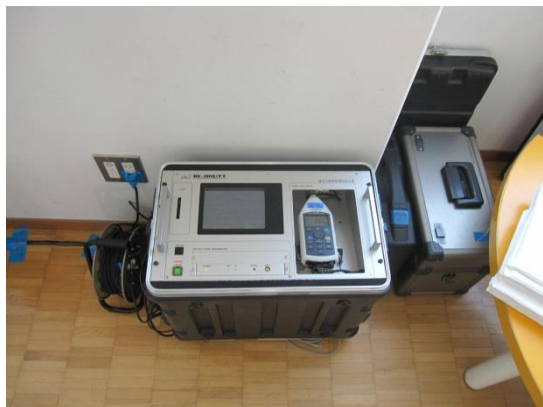
明海 騒音測定器本体設置状況
