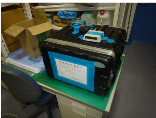
千鳥 騒音測定器本体設置状況
