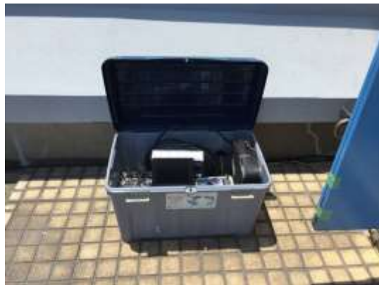
千鳥 ADSB受信装置本体設置状況
