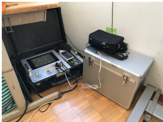
明海 騒音測定器本体設置状況
