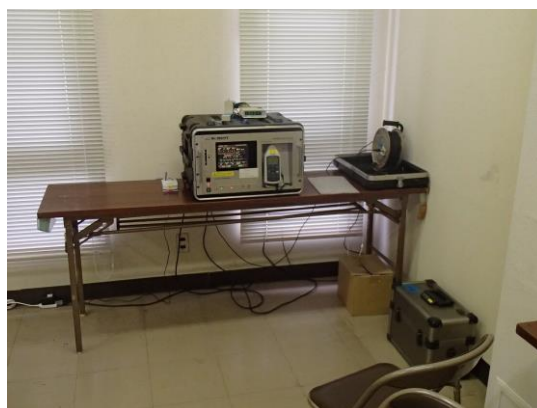
今川 騒音測定器本体設置状況
