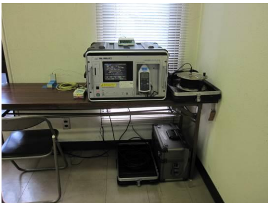
今川 騒音測定器本体設置状況
